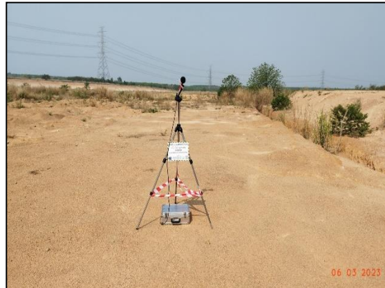
รูปที่ 3.11 ตรวจวัดระดับเสียง 15 นาที บริเวณ เครื่องจักร/เครื่องมือ ซึ่งเป็นแหล่งกำเนิดเสียงในการก่อสร้าง (N7)
