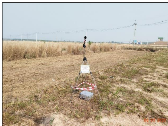
รูปที่ 3.10 ตรวจวัดระดับเสียง 15 นาที บริเวณ เครื่องจักร/เครื่องมือ ซึ่งเป็นแหล่งกำเนิดเสียงในการก่อสร้าง (N6)
