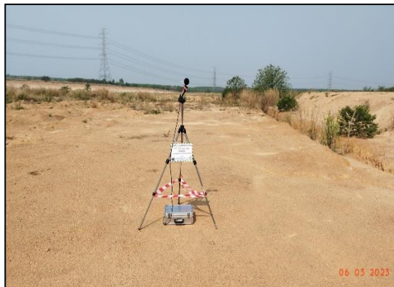
รูปที่ 3.9 ตรวจวัดระดับเสียง 15 นาที บริเวณ เครื่องจักร/เครื่องมือ ซึ่งเป็นแหล่งกำเนิดเสียงในการก่อสร้าง (N5)
